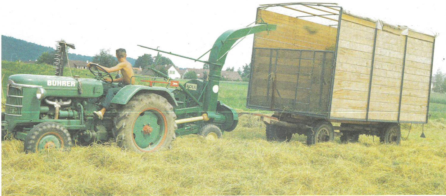
Die Zapfwelle verhalf der Motorisierung in der Landwirtschaft zum Durchbruch. Erst jetzt wurden die Traktoren zu vielseitig verwendbaren Kraftzentren, die die Pferde als Zugtiere verdrängten.
