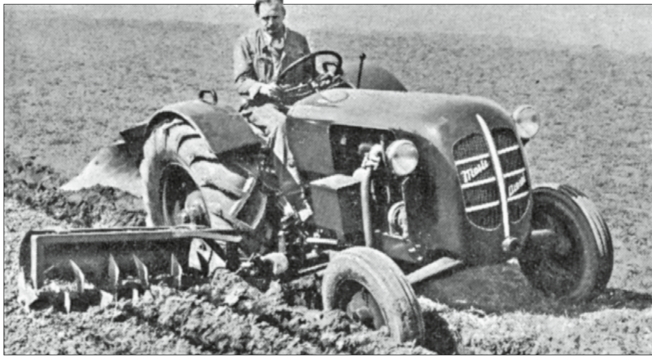
Die Zapfwelle ermöglichte es Traktoren, sowohl Geräte zu ziehen als auch Arbeitsmaschinen anzutreiben. So konnten erstmals auch mehrere Arbeitsprozesse in einem Durchgang erledigt werden.
